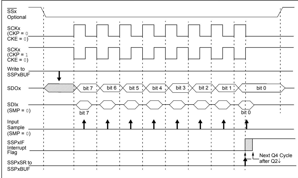
**FIGURE 20-6: SPI MODE WAVEFORM (SLAVE MODE WITH CKE = 1)**
