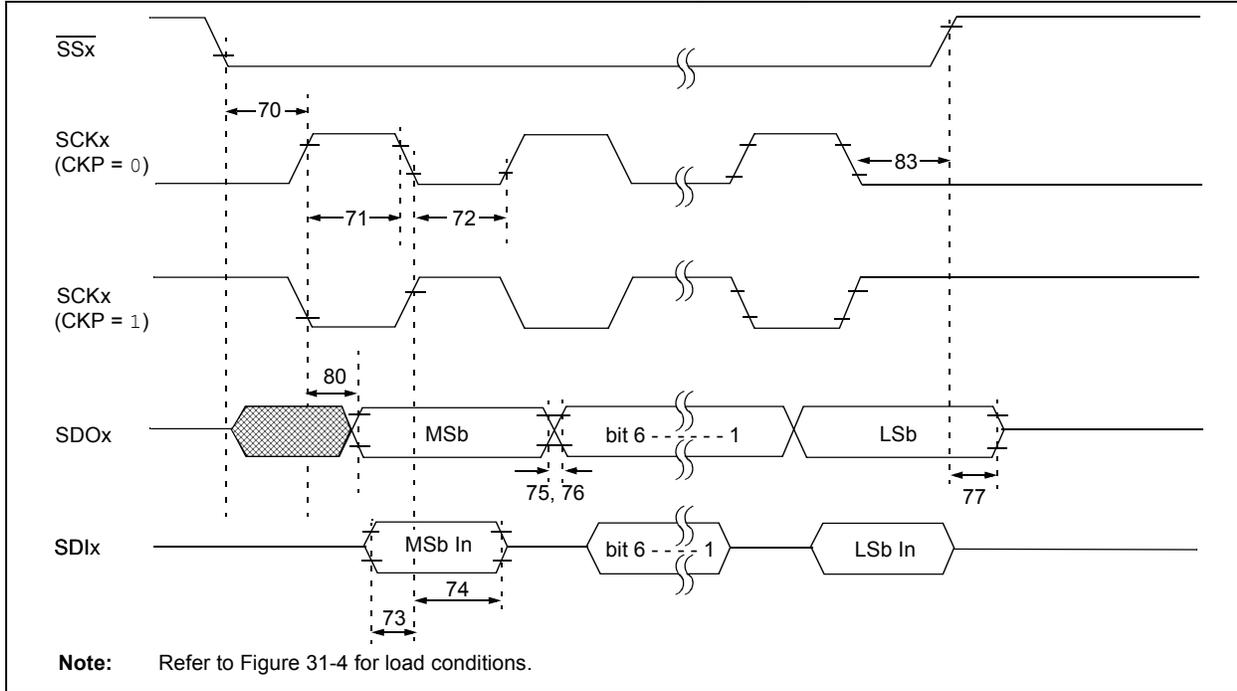
**TABLE 31-22: EXAMPLE SPI MODE REQUIREMENTS (SLAVE MODE TIMING, CKE = 0)**
