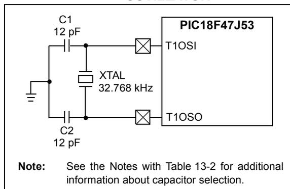
**TABLE 13-2: CAPACITOR SELECTION FOR THE TIMER OSCILLATOR<sup>(2,3,4,5)</sup>**
