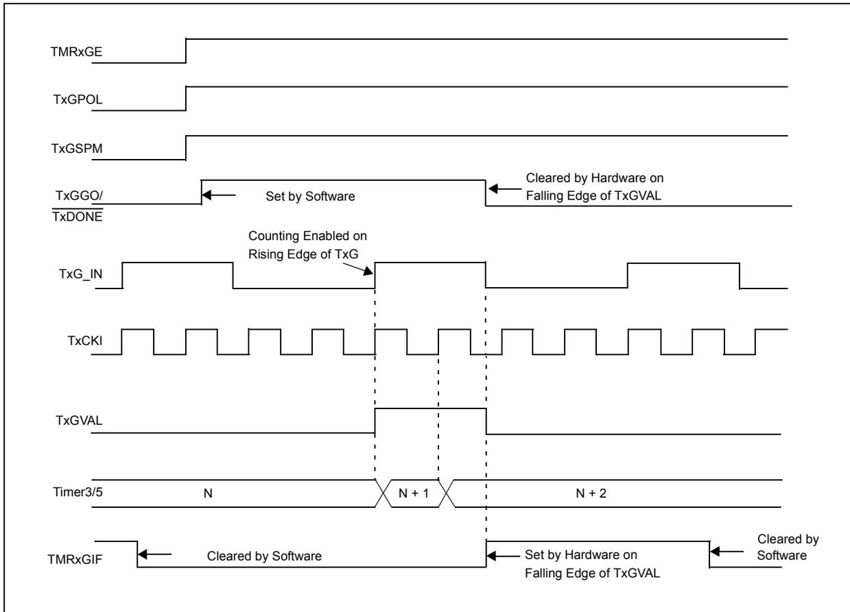
**FIGURE 15-5: TIMER3/5 GATE SINGLE PULSE AND TOGGLE COMBINED MODE**
